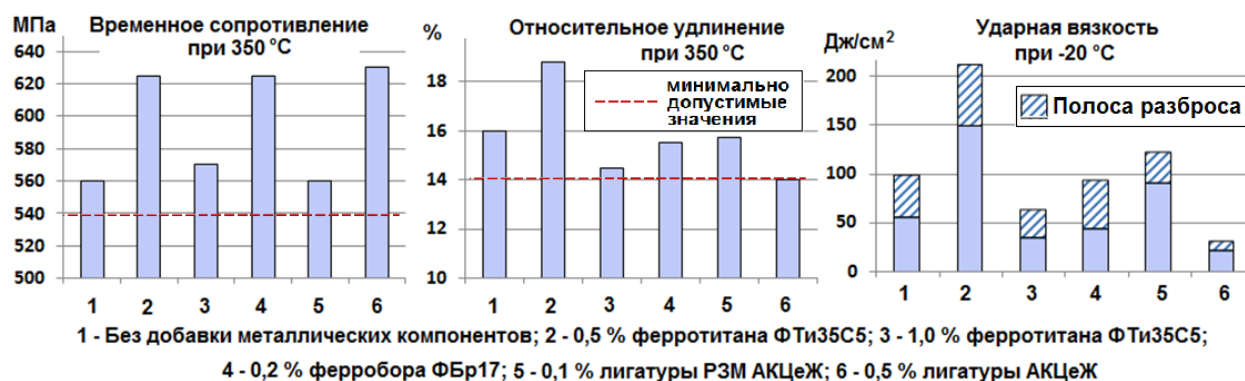
Рис. 5. Зависимость механических свойств металла шва от содержания модифицирующих металлических добавок в составе флюса (проволока Св-10ХМФТУ-А, отпуск с LMP=19,87 )
