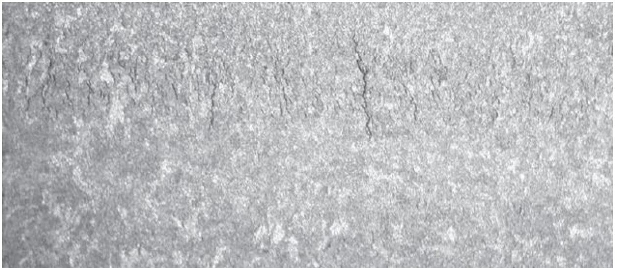
Рис. 1.2. Поверхность сварного шва 2\frac{1}{4}\text{Cr}-1\text{Mo}-\frac{1}{4}\text{V} с поперечными трещинами повторного нагрева
