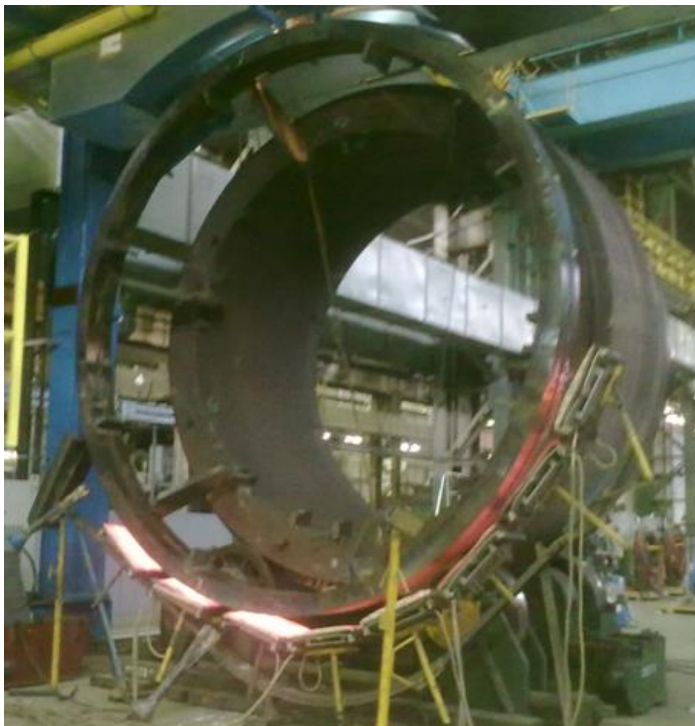
Рис. 5.1. Сварка натурной кольцевой пробы в условиях ОАО «Ижорские заводы»
