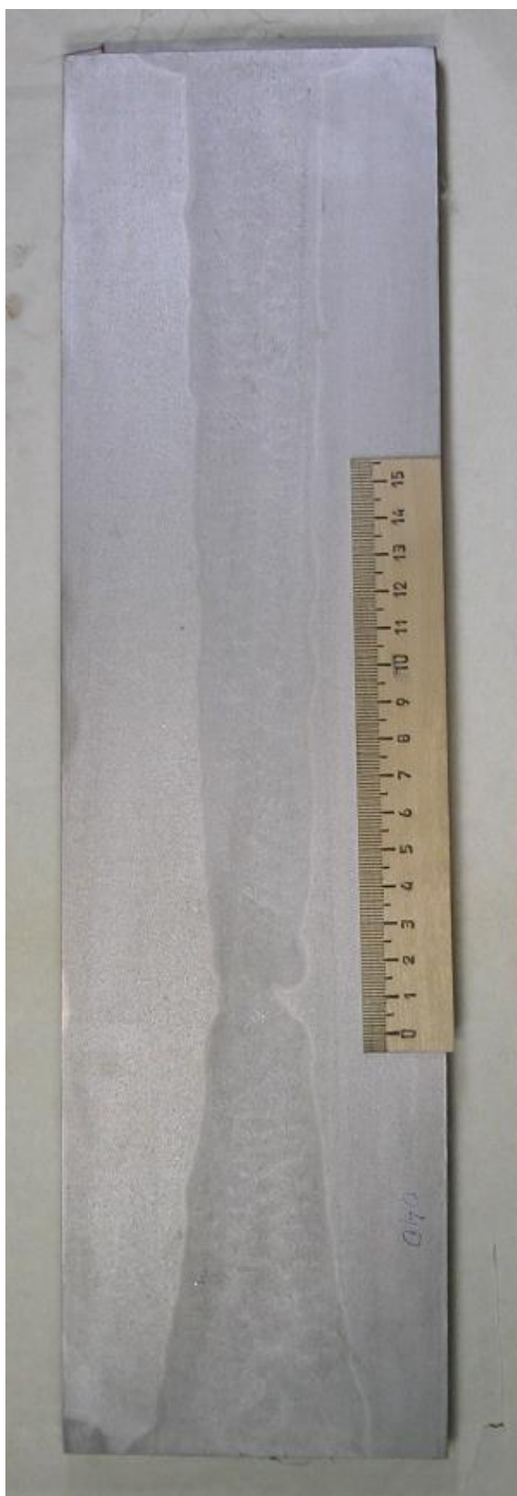
Рис. 5.4. Макроструктура сварного соединения, выполненного в условиях производственной площадки филиала «Атоммаш» АО «АЭМ-технологии»
