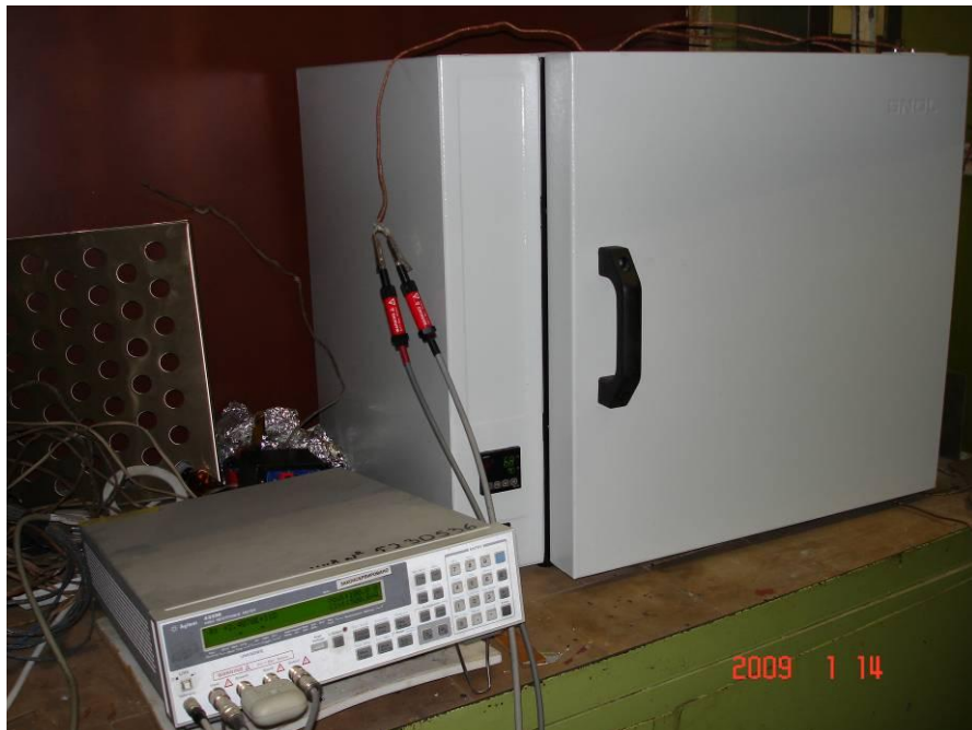
Рисунок 2.4. Внешний вид прибора Agilent 4339В с лабораторным термостатом.
