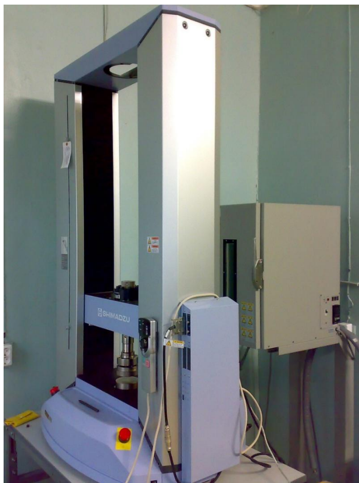
Рисунок 2.1. Испытательная машина Shimadzu AGX-50kN с термокамерой.
