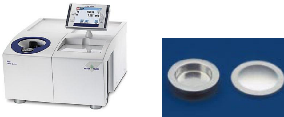
Рисунок 2.8. Внешний вид прибора Mettler Toledo DSC1 и стандартный, алюминиевый тигель.
