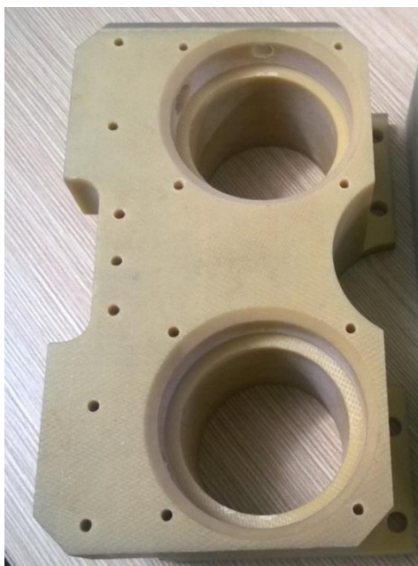
Рисунок 5.5 Деталь корпуса газоразрядного прожектора, изготовленная из стеклопластика СТЭТ-2.
