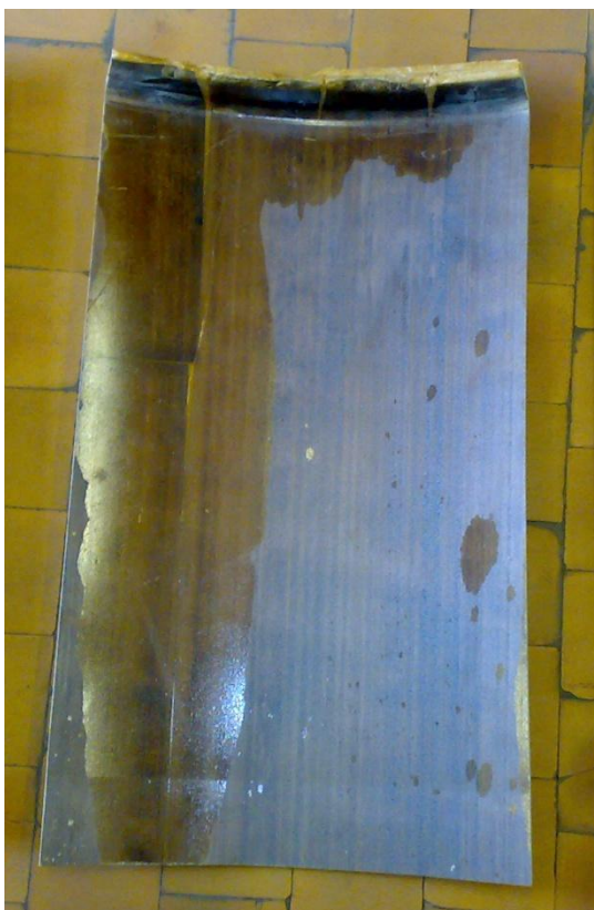
Рисунок 5.3. Фото сектора подбандажной изоляции со слоем из стеклопластика СПФС.
