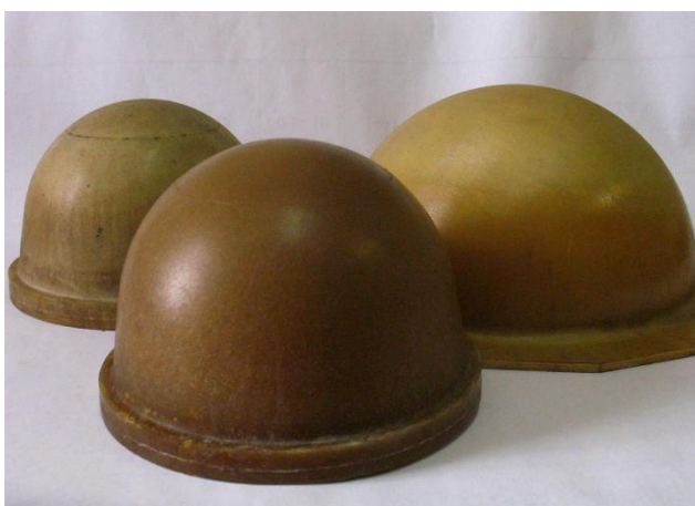
Рисунок 5.1. Антенные обтекатели из материала СТЭТ-2.
