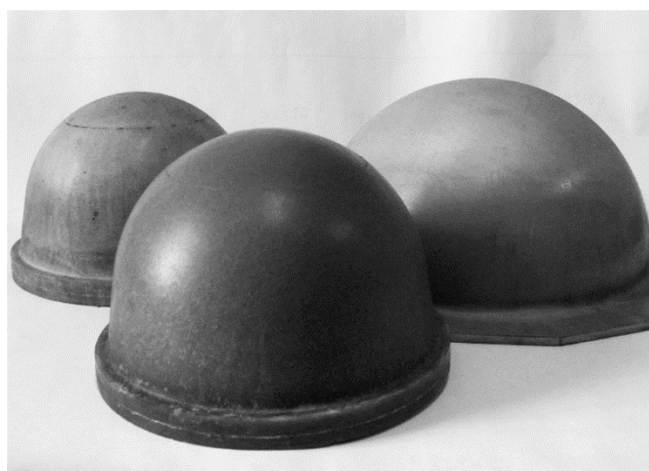
Рисунок 10. Антенные обтекатели из материала СТЭТ-2.
