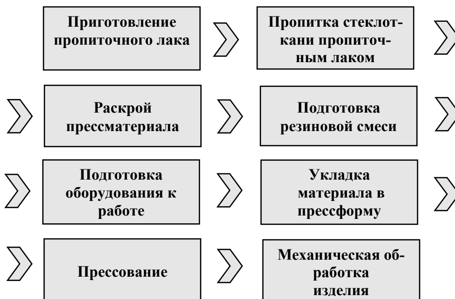
Рисунок 4.8 Технологический процесс изготовления изоляционных основ с хлоростойким покрытием
