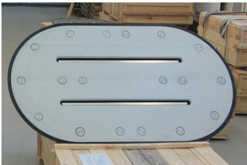
Рисунок 6.5 Анод типа АКЛ-3МУ с детонационным покрытием из смеси оксидов Al_2O_3+5\%Cr_2O_3
