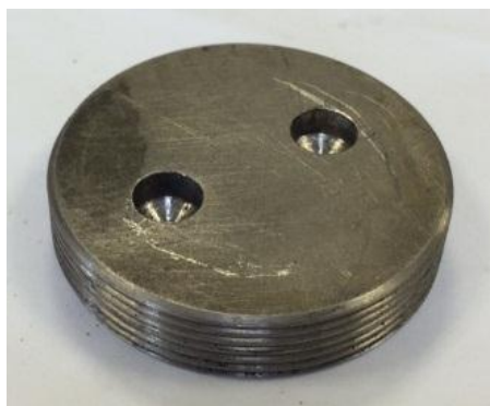
Рисунок 5.11 Заглушка монтажного отверстия защитного титанового листа анода типа АКК-М-4 после 9-ти лет катодной поляризации
