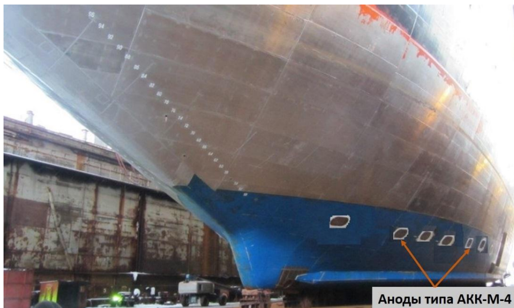
Рисунок 6.3 Аноды типа АКК-М-4, установленные на подводной части корпуса а/л «50 лет «Победы» при его постройке
