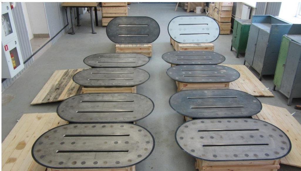
Рисунок 6.4 Аноды типа АКЛ-3МУ, изготовленные по договору с ФГУП «Атомфлот» для замены устаревших анодов типа АКК-М-4 катодной защиты а/л «50 лет «Победы»
