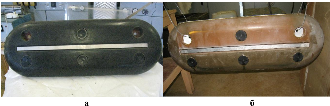
Рисунок 4.10 Внешний вид образца изоляционной основы из эпоксидного стеклопластика марки СТЭТ-1 с лакирующим слоем из силиконовой резины типа Пентасил-1513 до испытаний (а) и после (б)
