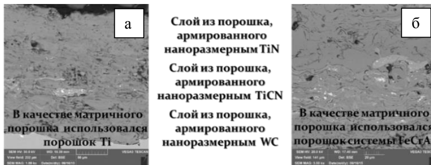
Рисунок 11. изображения поперечных шлифов ФГП, полученных чередованием композиционных армированных порошков на основе матриц из Ti а) и сплава Fe-Cr-Al б).
