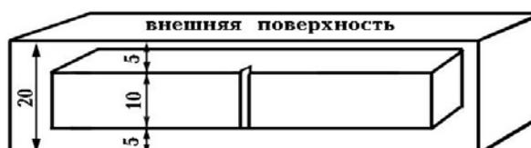
Рис. 2.4 – Схема расположения ударных образцов относительно стенки баллона
