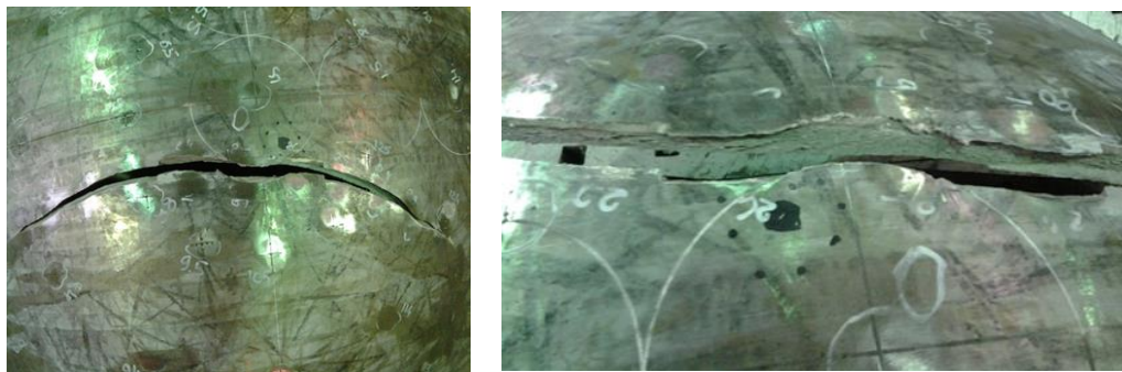
Рисунок 3.1 – Трещина в центральной зоне штамповки.
