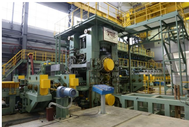
Рисунок 2.2 - Автоматизированный опытный прокатный комплекс стан «Кварто 800»
