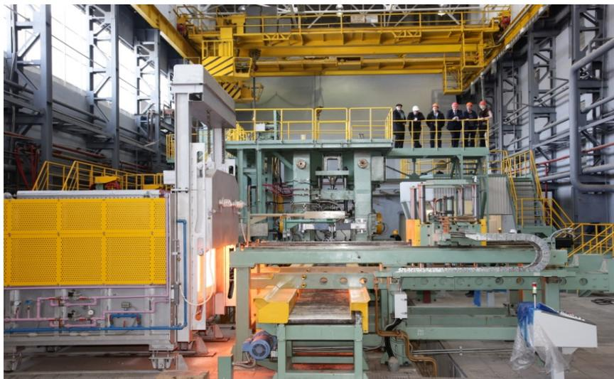
Рисунок 2.1 – Автоматизированный опытный прокатный комплекс «Стан кварто-800»
