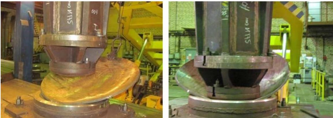
Рисунок 5.16 – Процесс гибки опытных листовых деталей
