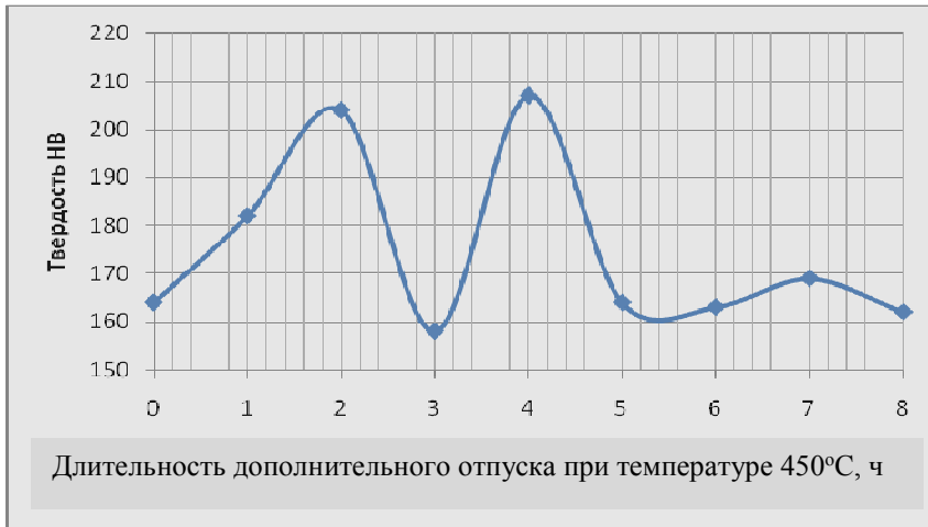
Рисунок 20 - Влияние длительности среднетемпературного дополнительного отпуска на твердость стали марки 10ГН2МФА.
