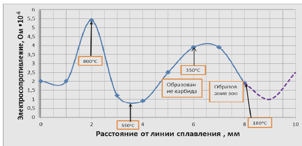
Рисунок 13 – Изменение электросопротивления ЗТВ сварного соединения в зависимости от расстояния от линии сплавления в сторону основного металла-поковки стали марки 09Г2СА-А.
