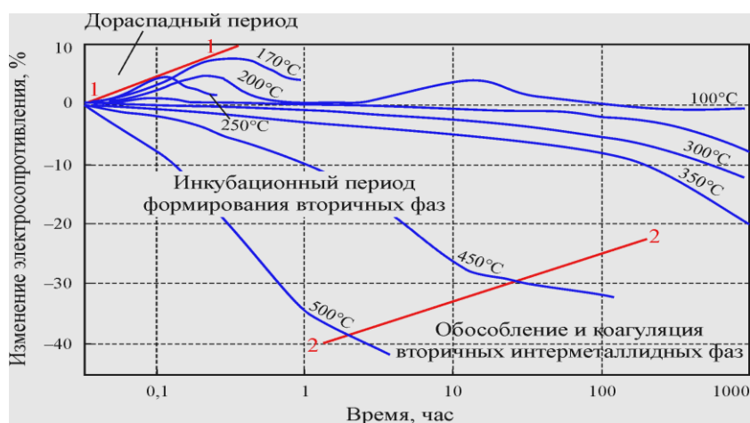
Рисунок 27 – Характер изменения электросопротивления в стали марки 01Н17К13М5ТЮ в зависимости от стадий распада мартенсита
