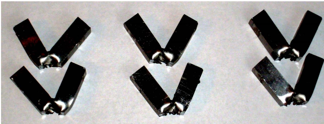
Рисунок 3 – Вид образцов после испытания на ударную вязкость при температуре минус 60°C (листовой прокат из стали марки 09Г2СА-А толщиной 25 мм).
