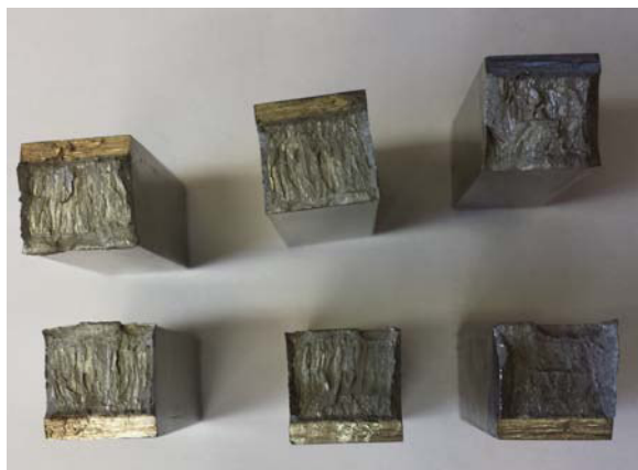
Рисунок 5.8 – Фотографии образцов из сварных соединений сталей марки 04X20H6Г11M2АФБ, сваренных с применением проволоки марки ЭП-263Ш, после испытаний на ударную вязкость
