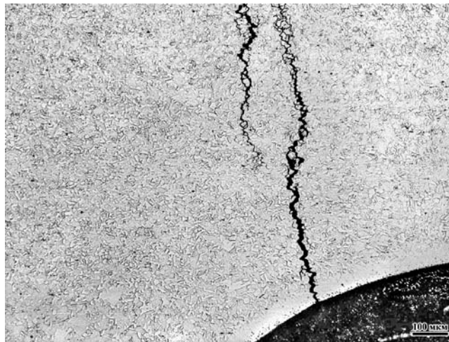
Рисунок 4.5 – Трещины в околошовной зоне стали при наплавке сплавов типа «Аврора»
