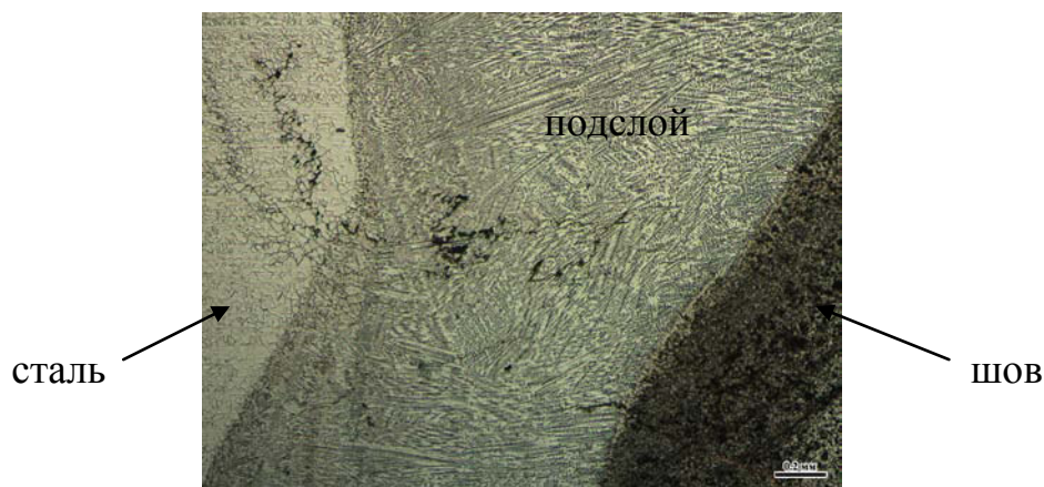
Рисунок 5.1 – Трещины в стали и подслое при сварке с одним слоем подслоя
