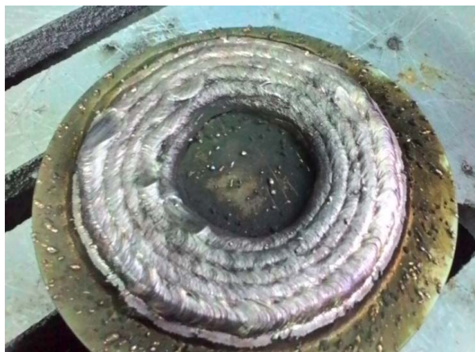
Рисунок 6.9 – Внешний вид подслоя, наплавленного сварочной проволокой марки МНЖКТ5-1-0,2-0,2 на бронзу БрА9Ж4Н4Мц1 в 2 слоя
