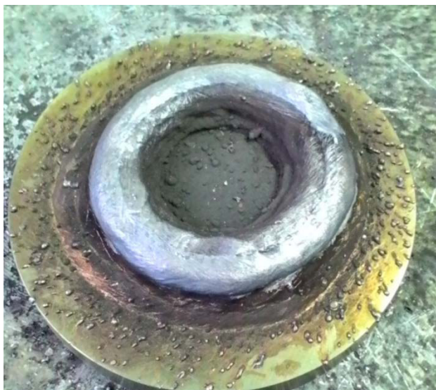
Рисунок 6.11 – Вид модели уплотнительного поля после наплавки по высоте двух слоев подслоя и трех слоев основного слоя
