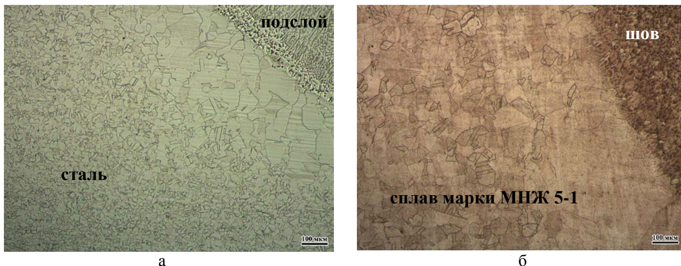
Рисунок 5.15 – Зоны сплавления стали с металлом подслоя (а) и сплава МНЖ 5-1 с металлом шва (б)
