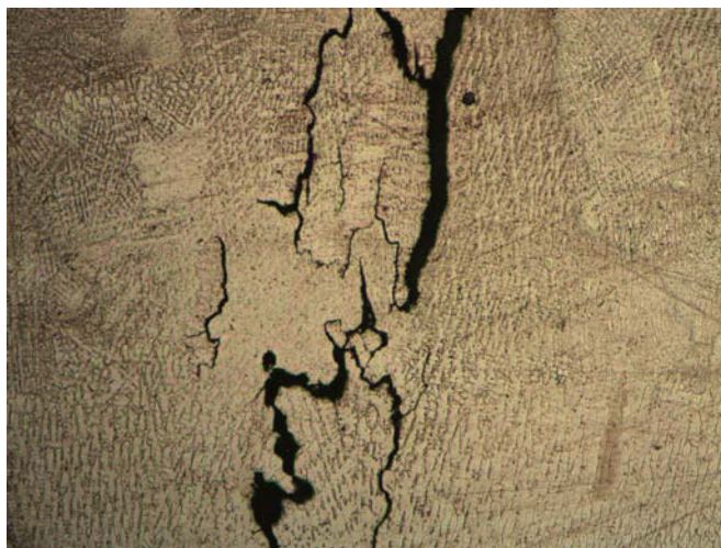
Рисунок 4.26 – Трещина в металле, наплавленном сварочной проволокой марки Св-МНЖМцТК40-1-1-0,3-0,1 на алюминиевую бронзу БрАМц9-2 (увеличение \times 200 )
