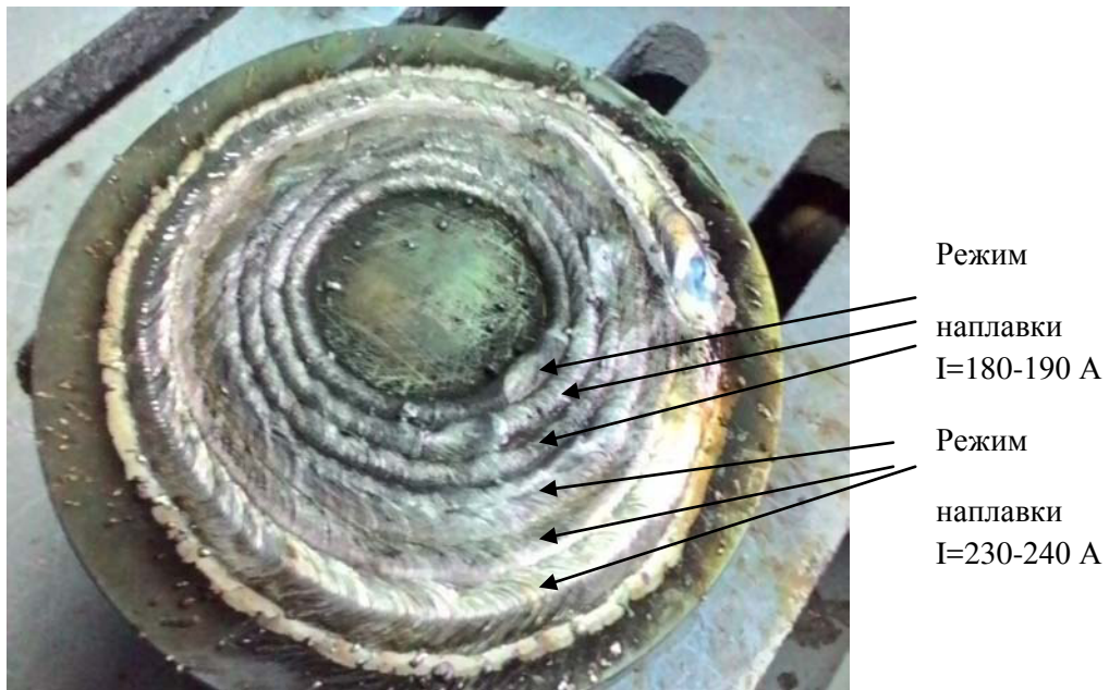
Рисунок 6.7 – Сравнение формирования наплавленной поверхности подслоя на исходном режиме: ( I=180-190 А и U= 23-24 В) и новом: I=230-240 А (скорость подачи 8,4-8,5 м/мин) и U= 24-25 В.
