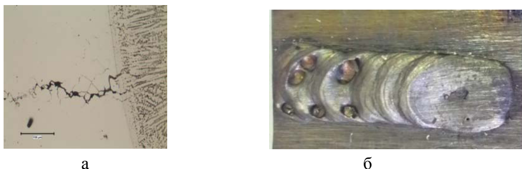
Рисунок 4.3 – Трещины в околошовной зоне стали (а) и сильная пористость (б) при наплавке монель-металла на сталь
