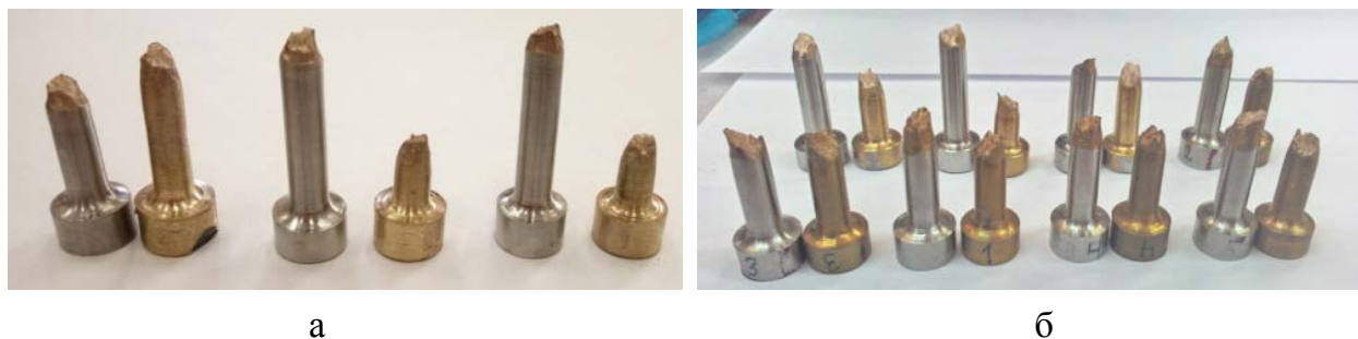
Рисунок 4.36 – Вид цилиндрических образцов на статическое растяжение из сварных соединений, изготовленных ручным (а) и механизированным (б) способами
