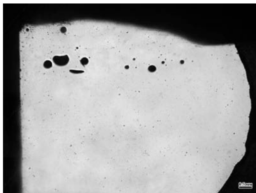
Рисунок 4.9 – Порыв металле, наплавленном сварочной проволокой ХН78Т на сталь 04X20H6Г11M2АФБ
