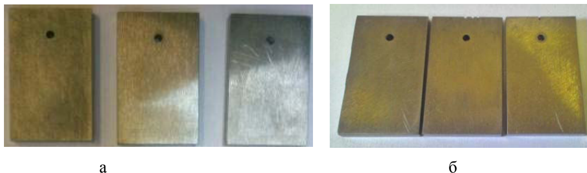
Рисунок 6.3 – Образцы на избирательную коррозию до испытаний (а) и после испытаний (б) металла, наплавленного сварочной проволокой марки Св-МНЖМцТК40-1-1-0,3-0,1
