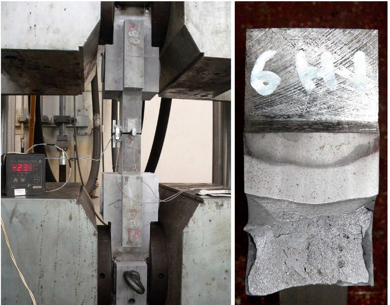
Рисунок 3.15,б — Образец SENT (pin loaded). Процесс испытания и вид излома.
