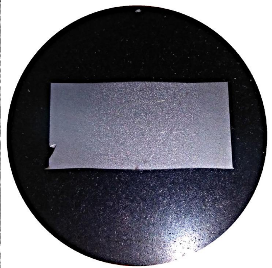
Рисунок 4.17 — Результат многократного термического циклирования, достигнутый на пробном образце после примерно 20ти термических циклов сварки: a) размер зерна в зоне максимального нагрева, б) утолщение в зоне максимального нагрева вследствие многократной перекристаллизации и разрыхления структуры.
