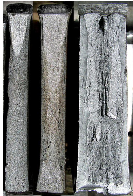
Рисунок 6.17 — Вид изломов образцов DWTG из стали 09Г2С толщиной 8-27 мм.
