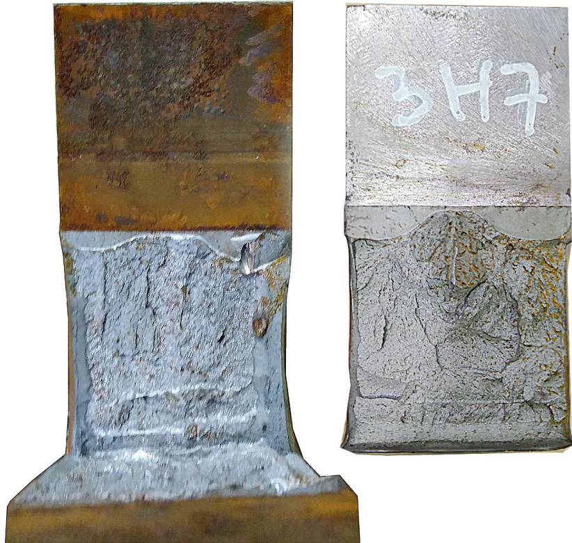
Рисунок 3.37 — Некорректная форма усталостной трещины в сварных образцах проката судостроительной стали (слева – толщиной 70 мм, автоматическая сварка под флюсом, справа – толщиной 40 мм, полуавтоматическая сварка в защитном газе)
