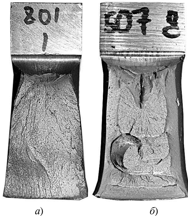
Рисунок 6.21 — Вид излома образцов T_{КБ} : а) преимущественно кристаллический, б) чередующийся.
