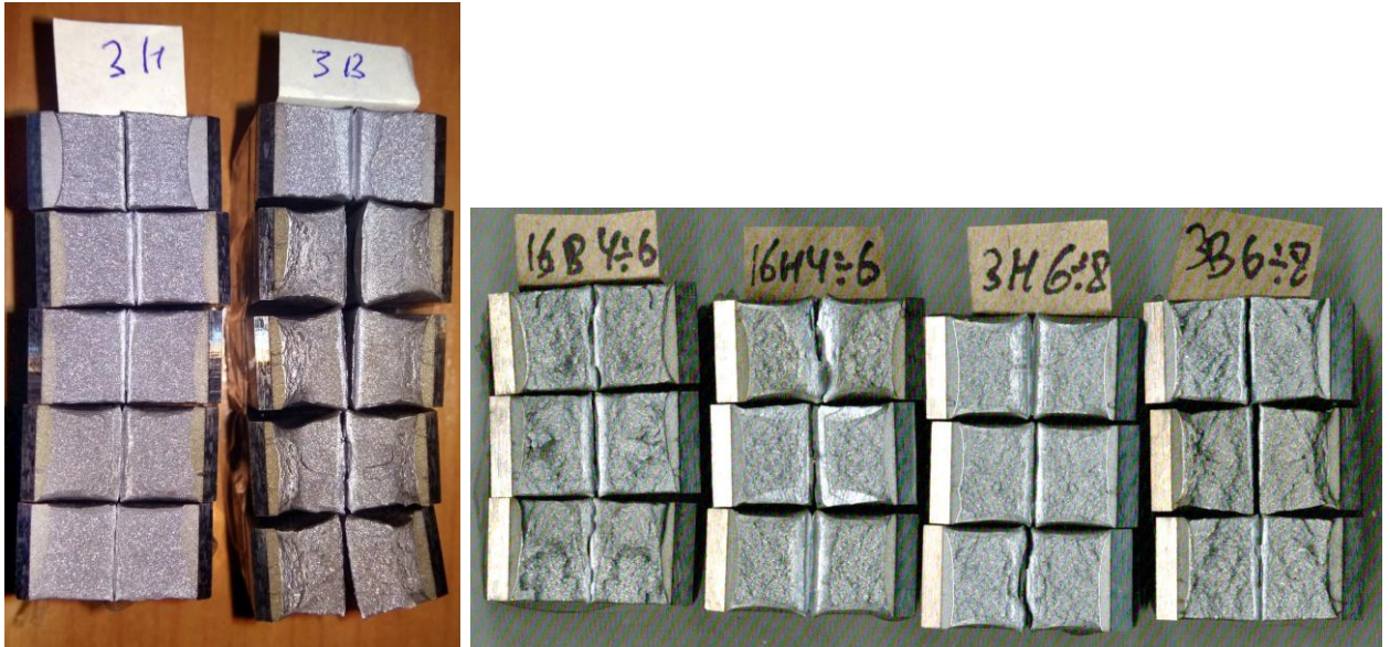
Рисунок 4.18 — Изломы образцов SENB стали E500 с имитированной ЗТВ (слева порядковые номера с 1 по 5)
