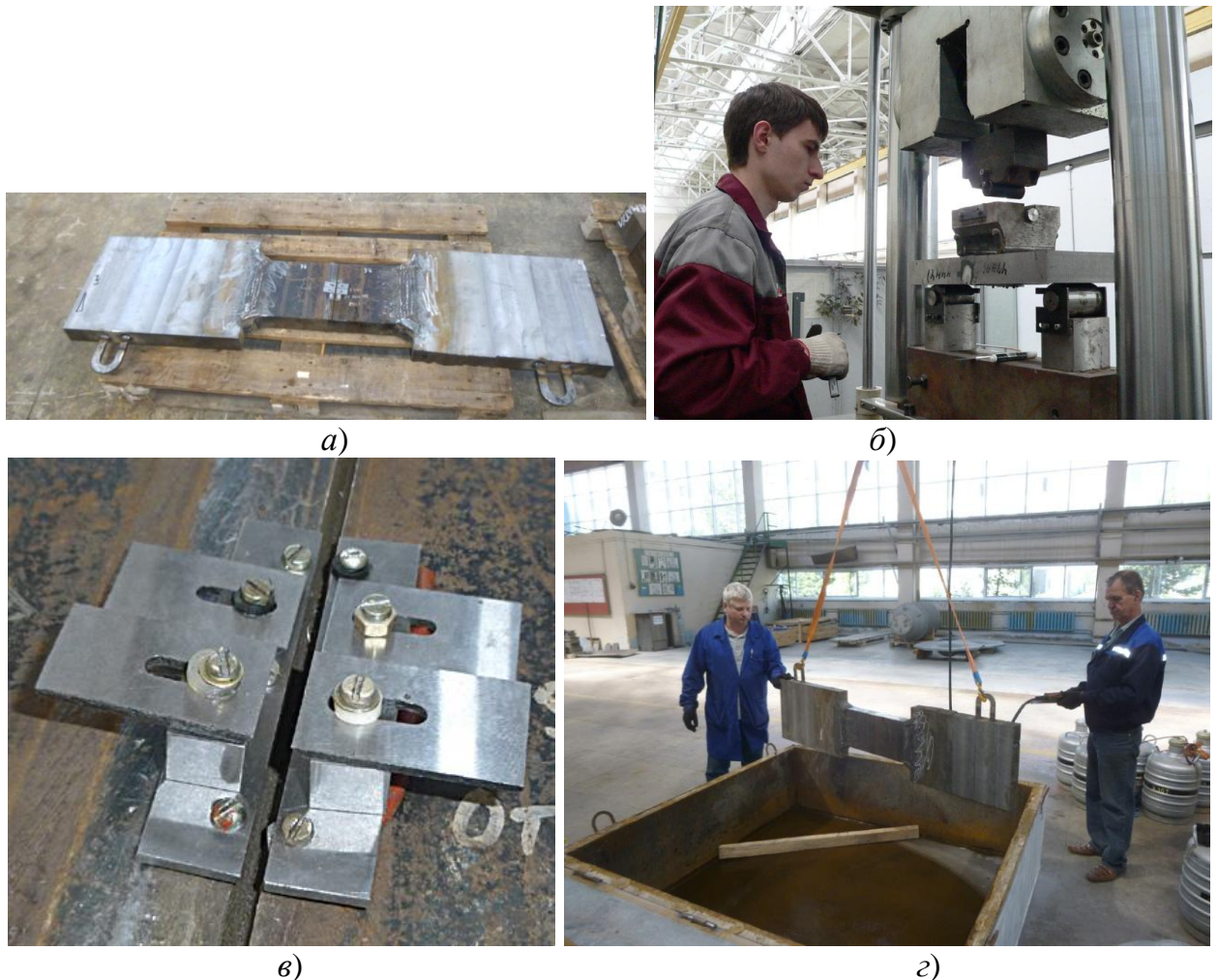
Рисунок 3.17, а-г – Проведение эксперимента на крупномасштабных образцах: а – внешний вид образца, б – предварительное выращивание усталостной трещины до приварки захватных частей, в – установка ножей датчиков раскрытия (надрез выполнен по линии сплавления), г – охлаждение жидким азотом в термостате перед испытанием.
