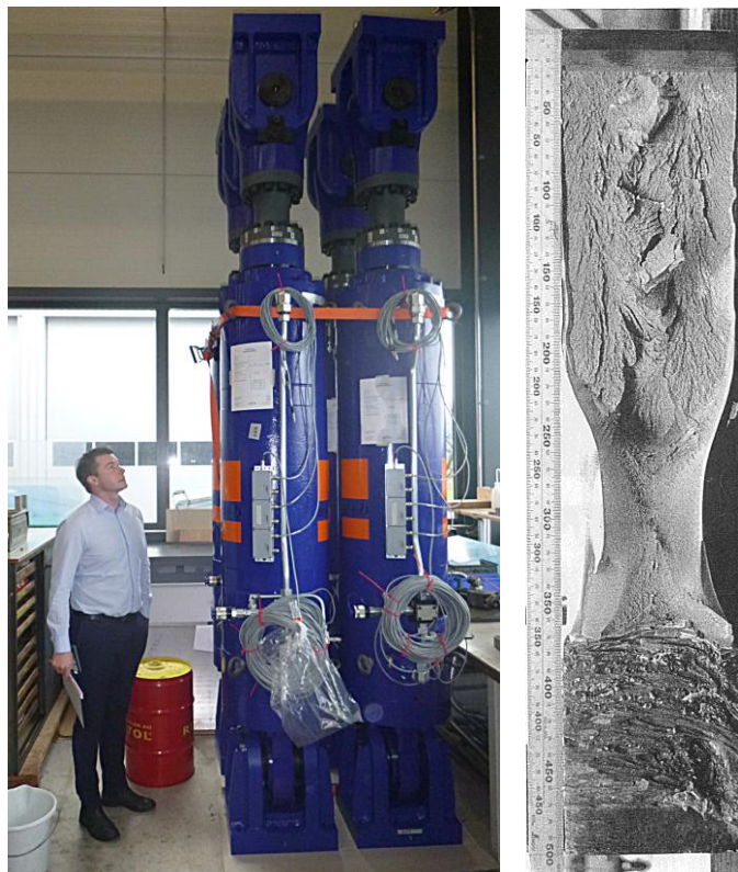
Рисунок 1.27 — Актуаторы для горизонтальной машины мощностью 60 МН, изготовленные для китайского Научно-исследовательского центра судостроения.
