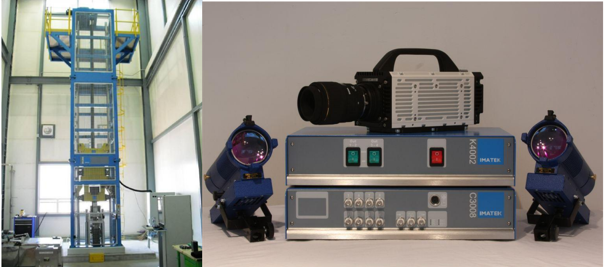
Рисунок 6.9 – Современный копёр с энергией падающего груза 100 кДж и высокоскоростная оптическая измерительная система
