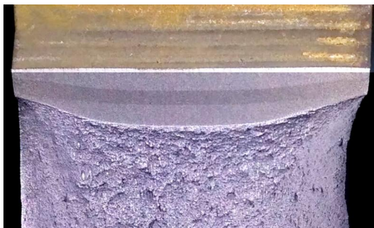
Рисунок 3.39 – Фрагмент излома образца проката судостроительной стали марки F500W толщиной 40 мм, для которой в отсутствие применения специальных технологических приёмов наблюдалось значительное туннелирование усталостной трещины. Видны три участка усталостной трещины, выращенные при различной асимметрии цикла.
