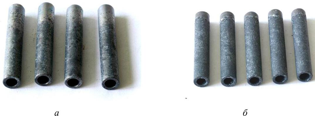
Рисунок 4.6 – Образцы после испытаний на горячесолевую коррозию после 100 ч при температуре 250°C (а) 310°C (б) (сплавы Ti-Al-Zr и Ti-Al-Zr-Ru)
