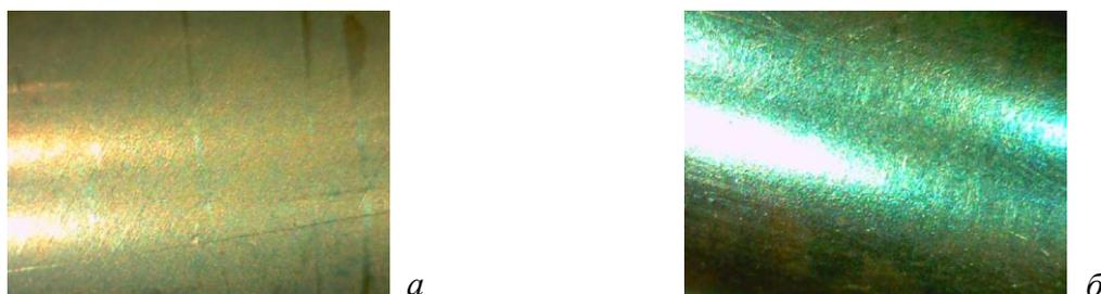
Рисунок 4.5 – Поверхность образцов после испытаний на щелевую коррозию после 3000 ч при температуре 310°C ( $\times 50$ ) сплава титана Ti-Al-Zr-Ru (а) и Ti-Al-Zr (б)
