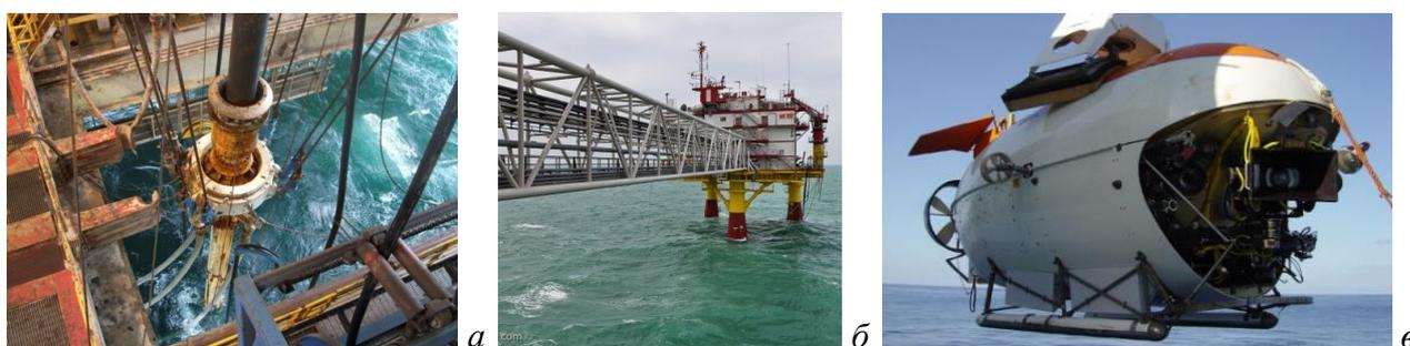
Рисунок 1.8 – Корпусные конструкции морской техники: *а* – конструкция райзера на добывающей платформе; *б* – конструкция райзера на ледостойкой стационарной платформе; *в* – глубоководный аппарат для обслуживания морской платформы
