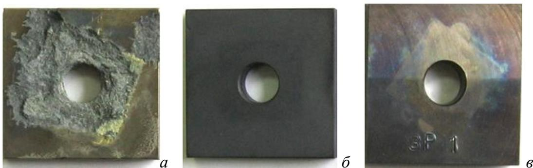
Рисунок 3.15 – Состояние поверхности образцов из сплава композиции Ti-Al-V после автоклавных испытаний. Образец без покрытия и без объемного легирования (а), со шликерным покрытием из окислов рутения (б), объемнолегированный рутением сплав (в)
