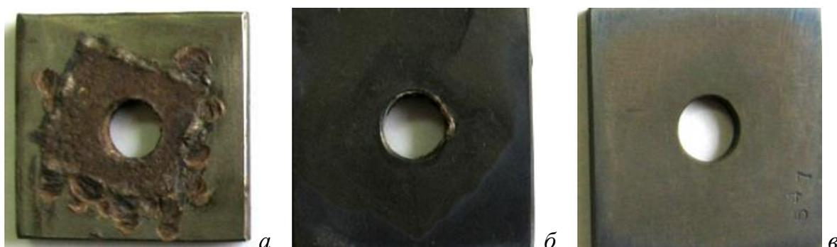
Рисунок 3.16 – Состояние поверхности образцов из сплава композиции Ti-Al-Mo-V после автоклавных испытаний. Образец без покрытия и без объемного легирования (а), со шликерным покрытием из окислов рутения (б), объемнолегированный рутением сплав (в)
