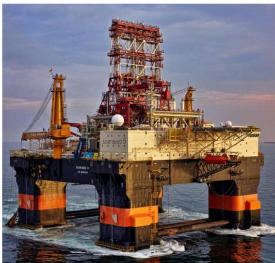
Рисунок 1.2 – Полупогружная буровая платформа Placid Green Canyon
