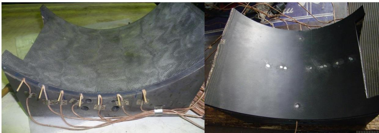
Рисунок 6.3. Оснащение термопарами и состояние поверхности вставки из антифрикционных теплостойких углепластиков ФУТ-Б(слева) и УПФС (справа) до начала проведения испытаний
