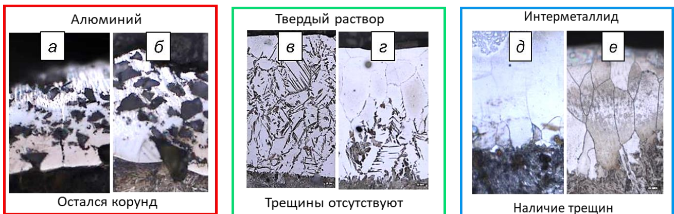
Рисунок 22 – Структура синтезированного слоя после обработки диодным лазером. Мощность 1680 Вт при скорости сканирования 15 мм/с (а); 5 мм/с (в); 10 мм/с (д). Мощность 1950 Вт при скорости сканирования 20 мм/с (б); 12,5 мм/с (г); 15 мм/с (е).
