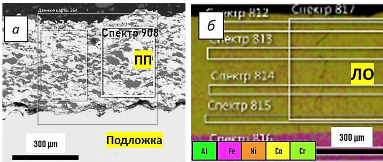
Рисунок 31 – ПП Al-Cr-Ni-Co полученного методом ХГДН (а); синтезированный слой расфокусированным источником (б)
