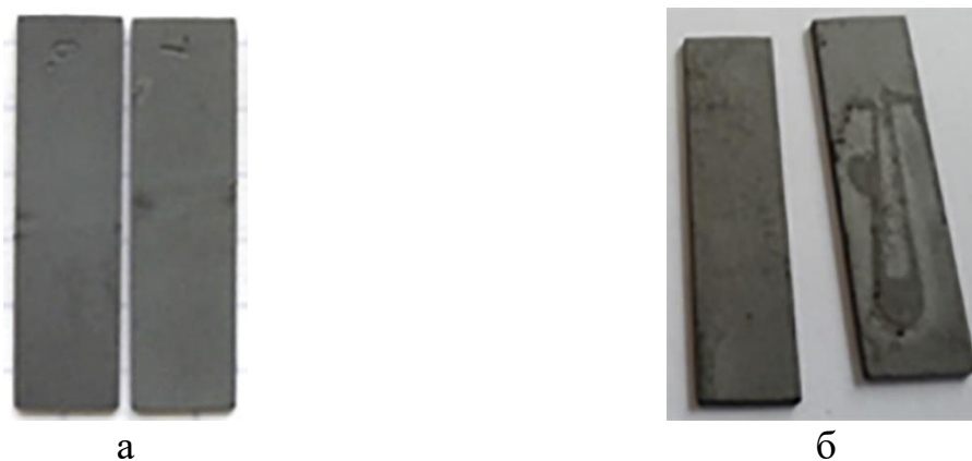
Рисунок 6.54 – Образцы из стали марки 07Х12НМФБ, после испытаний на сплошную и питтинговую коррозию в водной с содержанием 50 мг/л NaCl: а – температура 290 °С, длительность 4612 ч; б – температура 550 °С, длительность 1939 ч.
