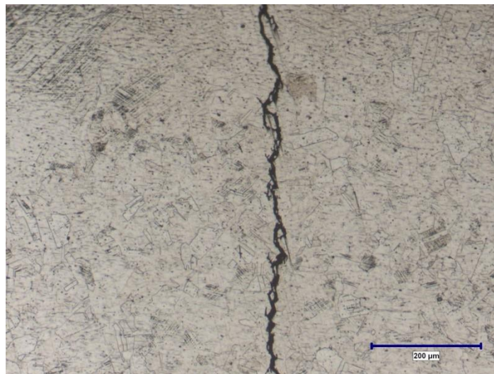
Рисунок 3.17 – Поперечное сечение трубы из стали марки 09Х18Н9 модуля ПП парогенератора ПГН-200М в области трещины, обнаруженной при капиллярном контроле
