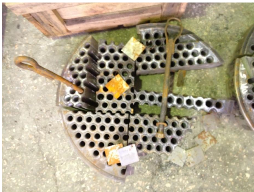
Рисунок 3.15 – Фрагменты верхней трубной доски модуля ПП парогенератора ПГН-200М.
