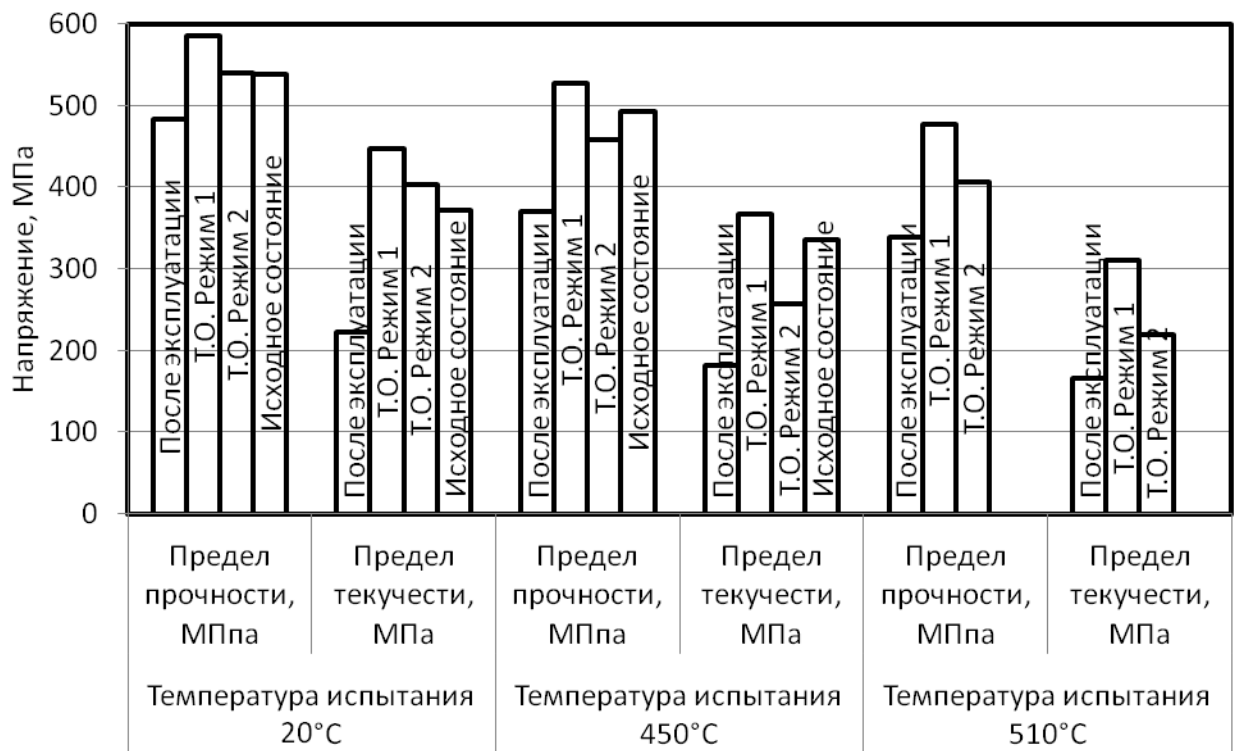
Рисунок 3.12 – Временное сопротивление и предел текучести стали марки 10X2М после эксплуатации при температуре 450 °С, с последующей имитационной термической обработкой по двум режимам и в исходном состоянии.
