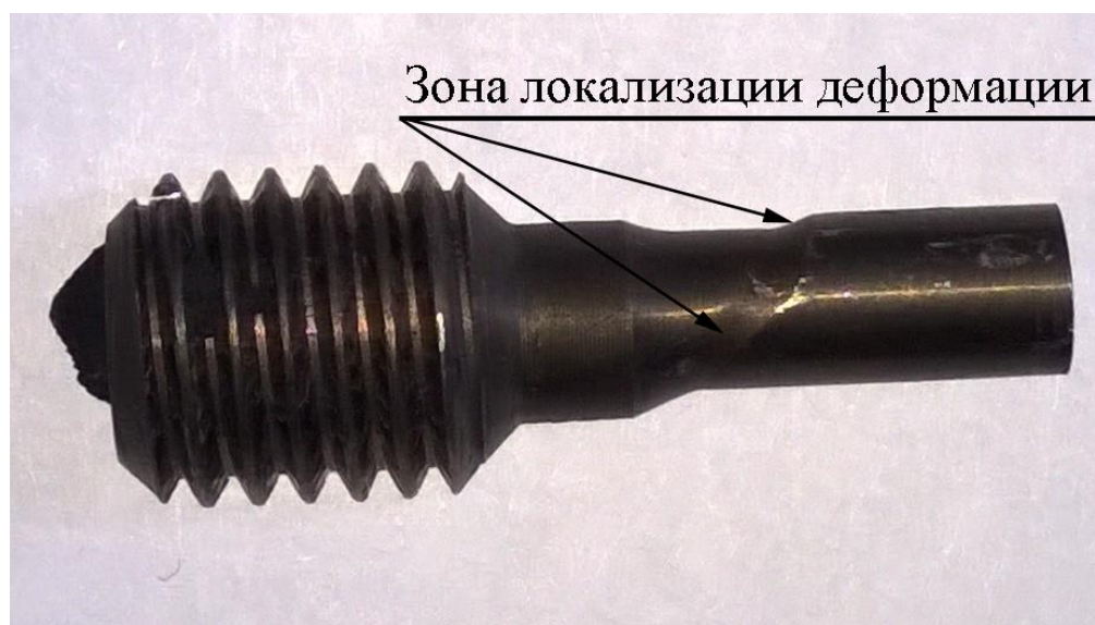
Рисунок 6.17 – Общий вид зоны локализации пластической деформации во фрагменте образца после испытаний на длительную прочность.
