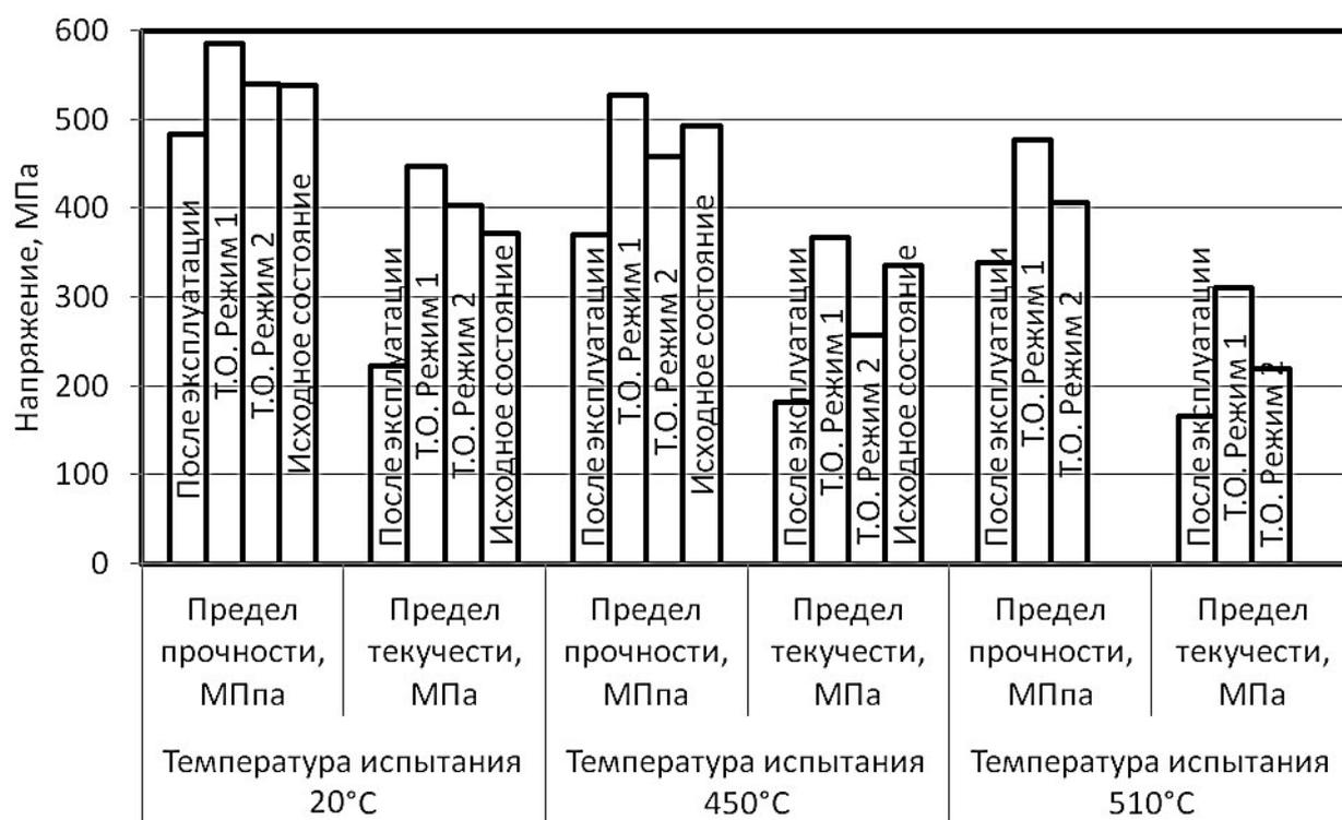
Рисунок 1 – Временное сопротивление и предел текучести стали марки 10X2M после эксплуатации при температуре 450 °С, в исходном состоянии и после термической обработки по двум режимам:
