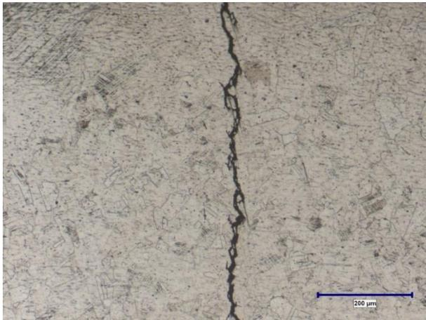
Рисунок 2 – Поперечное сечение трубы из стали марки 09X18H9 модуля ПП парогенератора ПГН-200М в области трещины, обнаруженной при капиллярном контроле
