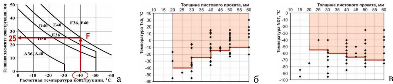
Рисунок 1 - Взаимосвязь максимальной толщины элемента конструкции с расчетной температурой эксплуатации для сталей категорий D, E, F (а). Значения критических температур Т<sub>кб</sub> (б) и NDT (в) в зависимости от толщины листового проката:
