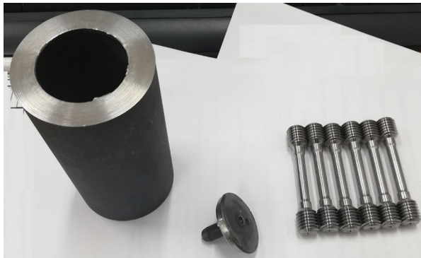
Рисунок 3.2 – Образцы из сплава марки СЛЖС5-ВИ и ампула перед проведением термической обработки
