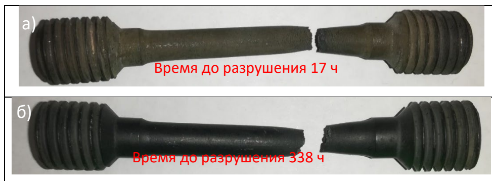
Рисунок 3.15 – Образцы из сплава марки СЛЖС5-ВИ после испытаний на длительную прочность при температуре 900°C и действующем напряжении 345 МПа а) старение без напряжения; б) термомеханическое нагружение сжатием
