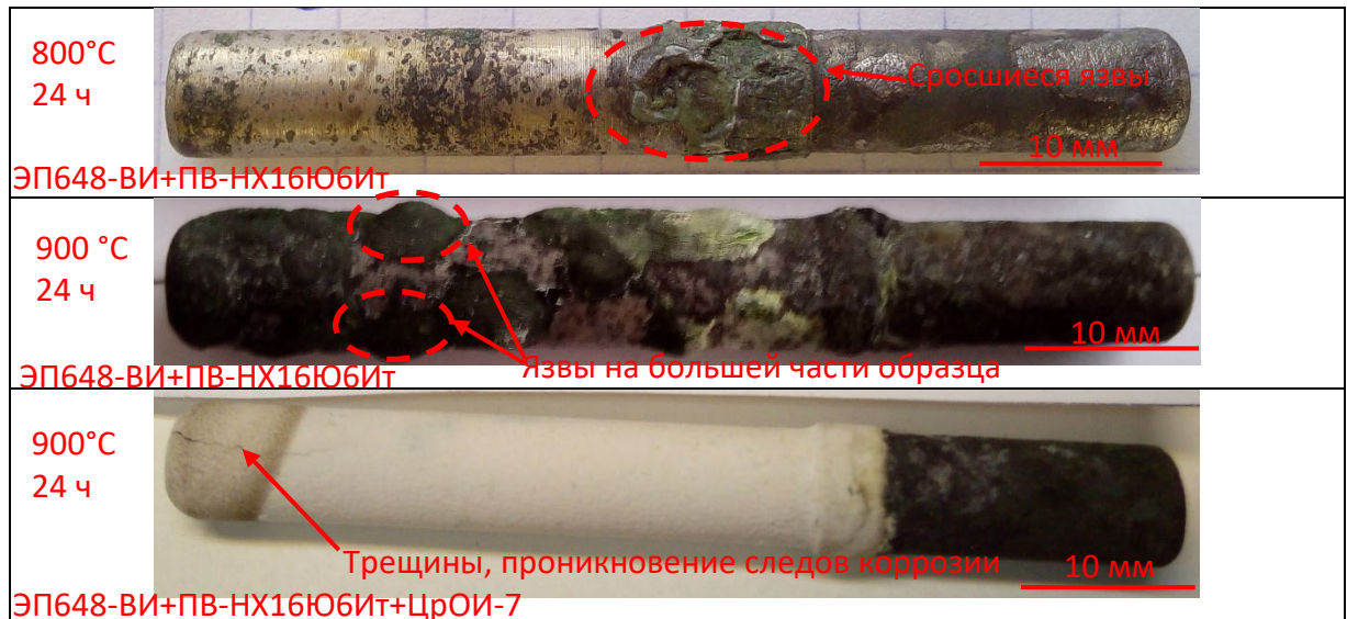
Рисунок 4.3 – Поверхность образцов сплава марки ЭП648-ВИ с защитными покрытиями после коррозионных испытаний в солевом расплаве состава 75% Na 2 SO 4 + 25% NaCl
