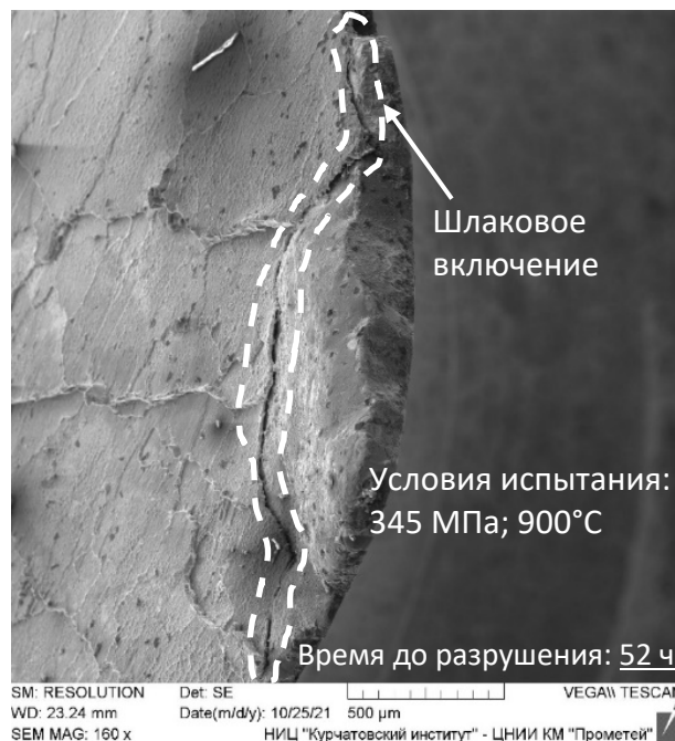
Рисунок 3.19 – Вид поверхности излома образца со шлаковым включением сплава СЛЖС5-ВИ, подвергнутого термомеханическому нагружению сжатием, после испытаний на длительную прочность
