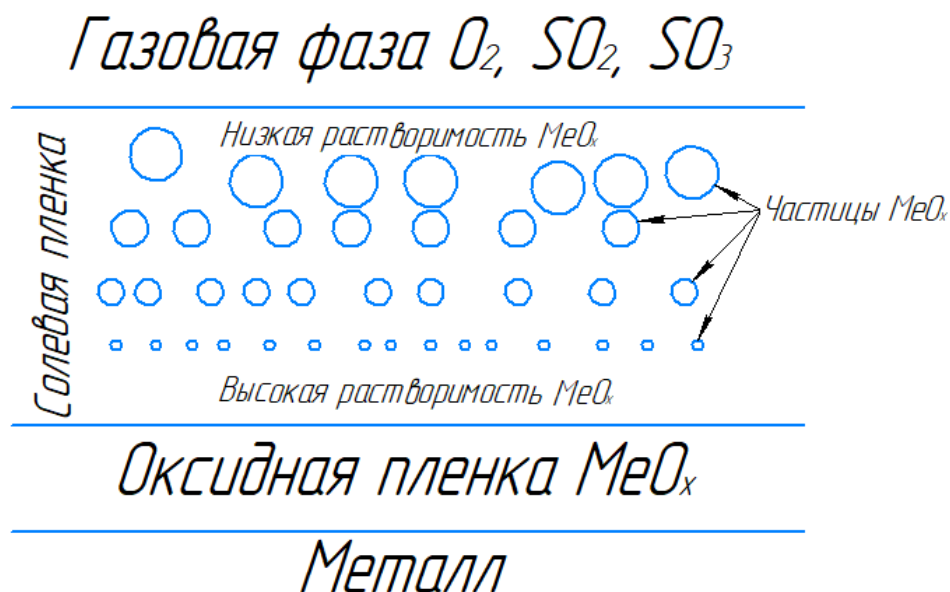
Рисунок 1.8 – Схема развития солевой коррозии по механизму солевого флюсования
