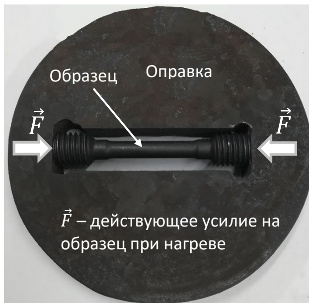
Рисунок 3.3 – Образец в оправке для прецизионного деформирования металла сжатием
