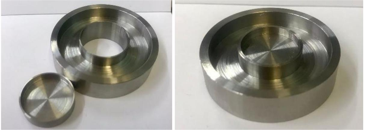
Рисунок 5.18 – Имитаторы корпуса в сборе с применением аддитивных деталей
