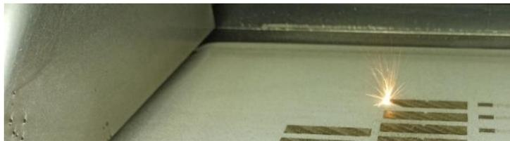
Рисунок 4.11 – Разлет частиц аддитивной стали 12X18Н10Т в камере установки СЛС
