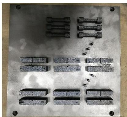
Рисунок 4.12 – Внешний вид СЛС образцов ПЖРВ
