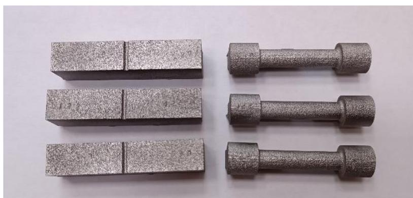
Рисунок 4.22 – Внешний вид СЛС образцов 80НХС
