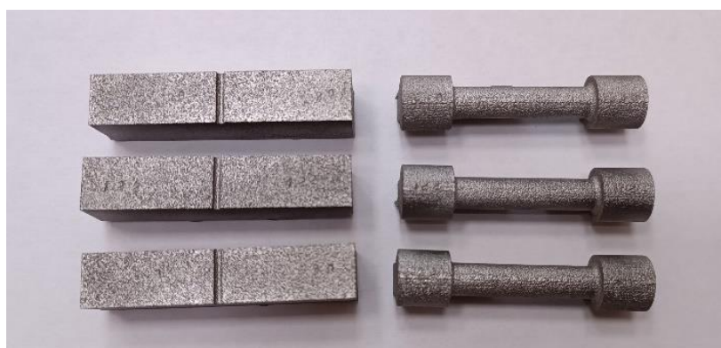
Рисунок 4.22 – Внешний вид СЛС образцов 80НХС
