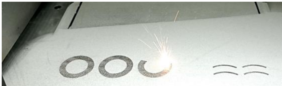
Рисунок 4.36 – Траектории разлета частиц и металлический пар в камере установки СЛС при сплавлении порошка 25X15К
