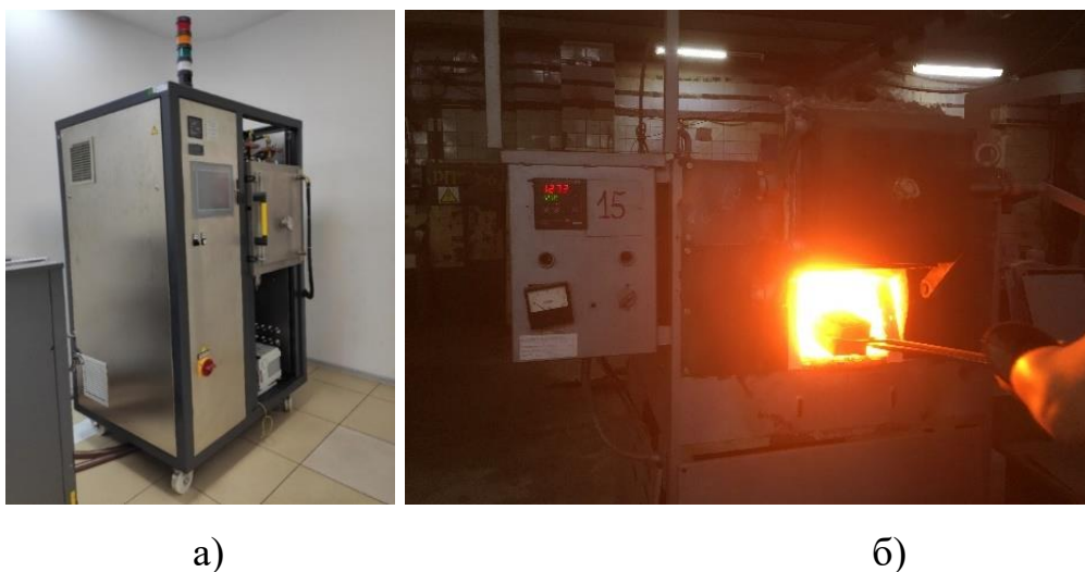
Рисунок 2.8 – Печи Nabertherm VHT 8/22 GR – а) и камерная – б)
