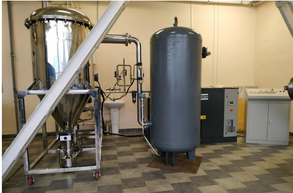
Рисунок 5.5 – Общий вид установки струйного измельчения
