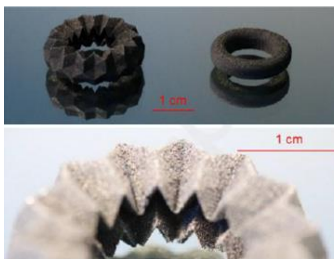
Рисунок 1.18 – Фотография напечатанных магнитов сложной формы. У магнитов есть внутренний канал охлаждения, дающий функциональные преимущества перед обычными постоянными магнитами [99]
