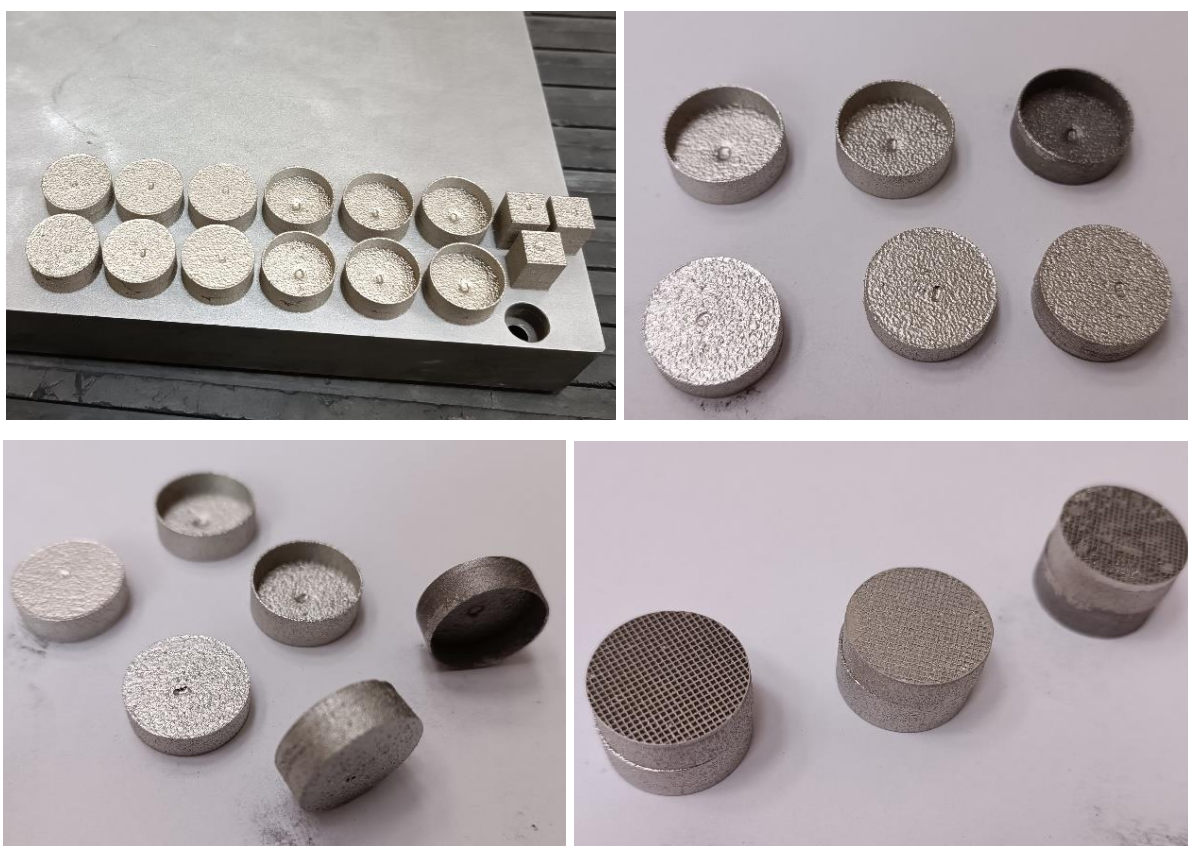
Рисунок 5.17 – Образцы деталей из сплава 80НХС, изготовленных по технологии СЛС
