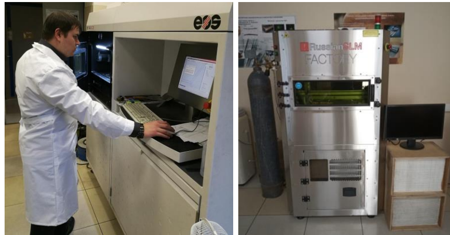
Рисунок 2.4 – Внешний вид установки EOSINT M270 – а) и Russian SLM FACTORY – б)
