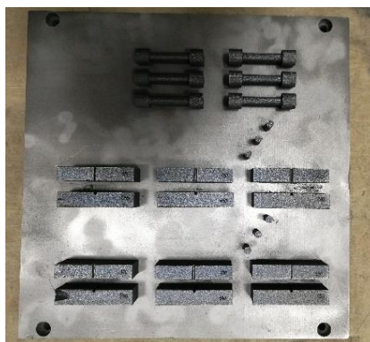
Рисунок 4.12 – Внешний вид СЛС образцов ПЖРВ
