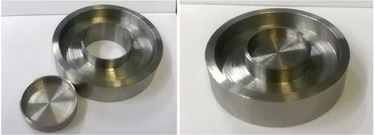
Рисунок 5.18 – Имитаторы корпуса в сборе с применением аддитивных деталей
