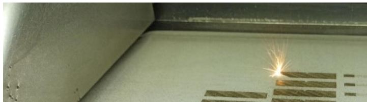
Рисунок 4.11 – Разлет частиц аддитивной стали 12X18H10T в камере установки СЛС
