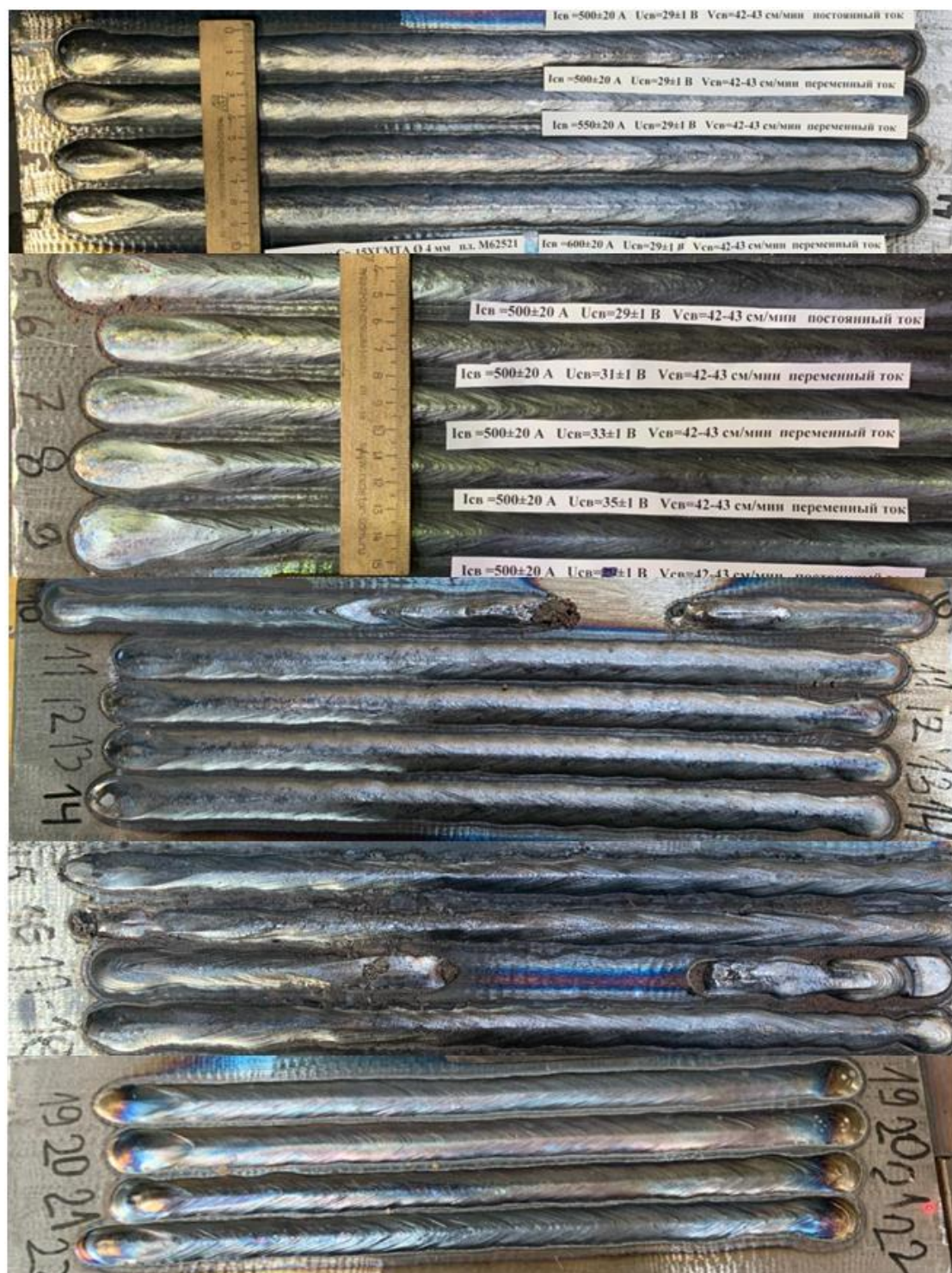
Рисунок 4.2 - Внешний вид наплавленных валиков №1-22 (сверху-вниз)
