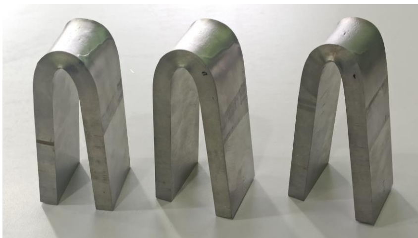
Рисунок 5.23 - Образцы на статический загиб сварного соединения после испытаний
