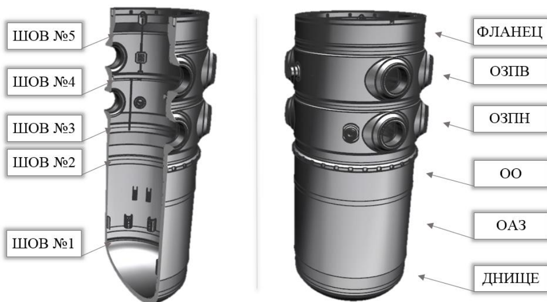
Рисунок 1.1 - Общий вид корпуса реактора ядерных установок с ВВЭР-1200 ОЗПВ, ОЗПН – обечайки зоны патрубков верхняя и нижняя, ОО – обечайка опорная, ОАЗ – обечайка активной зоны
