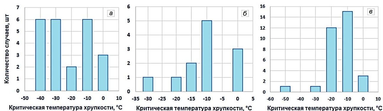
Рисунок 1.5 - Результаты определения T_{K0} металла шва КР ВВЭР из стали типа 15Х2НМФА, выполненного сварочными материалами: а – проволокой марки Св-10ХГНММА и Св-12Х2Н2ММА под флюсом ФЦ-16А; б – проволокой марки Св-08ХГНММА и Св-09ХГНМТАА-ВИ под флюсом НФ-18М; в – проволокой марки Св-09ХГНМТАА-ВИ под флюсом ФЦ-16А
