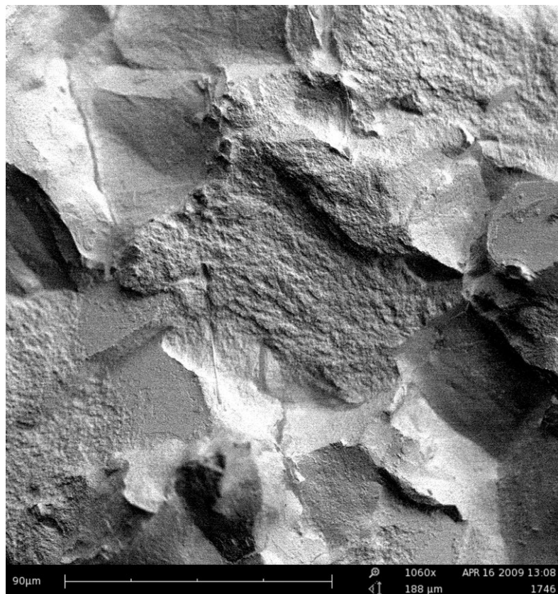
Рисунок 3.14 – Поверхность разрушения образца из стали 08X18N10T после ВТО, T_{исп} = 20^{\circ}\text{C} при увеличении 620х (а) и 1060х (б). Две основные моды разрушения – квазихрупкое внутризеренное и квазихрупкое межзеренное разрушение
