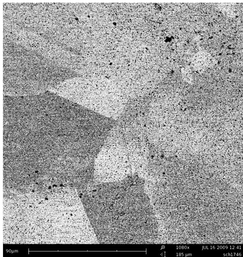
Рисунок 3.18 – Микроструктура стали 08X18N10T после НТО (шлиф поперек направления проката) при увеличении 385х (а) и 1080х (б)
