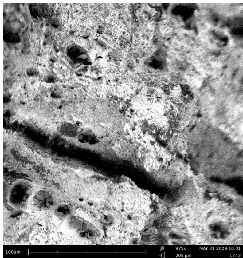
Рисунок 3.13 – Поверхность разрушения образца из стали 08X18H10T после НТО, T_{исп}=20\text{ }^{\circ}\text{C} при увеличении 605x (а) и 975x (б). Основная мода разрушения – вязкое межзеренное разрушение
