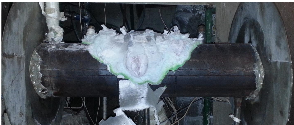
Рисунок 5.16 – Состояние модели с демонтированной теплоизоляцией после эксперимента № 2
