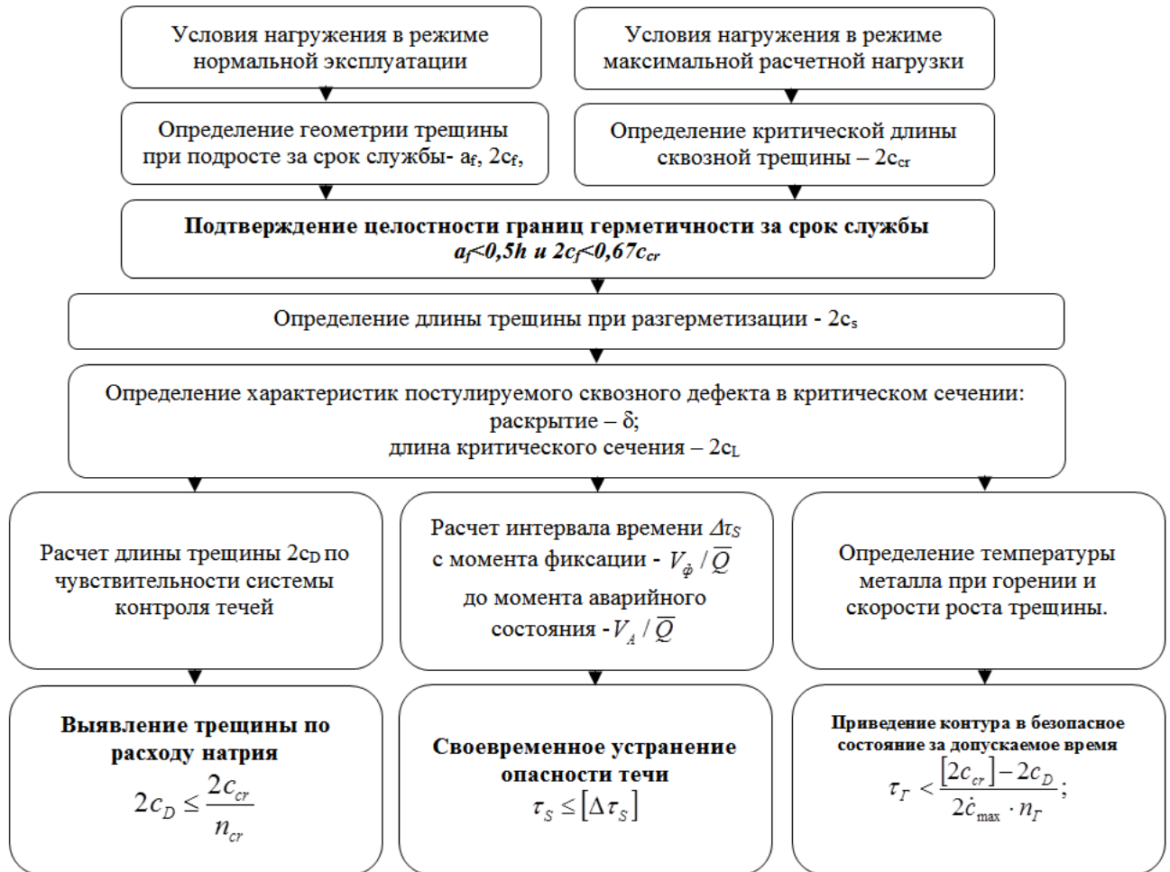
Рисунок 2.4 – Блок-схема процедуры подтверждения безопасности трубопроводов и корпусов оборудования 1 и 2 контуров РУ БН при разгерметизации
