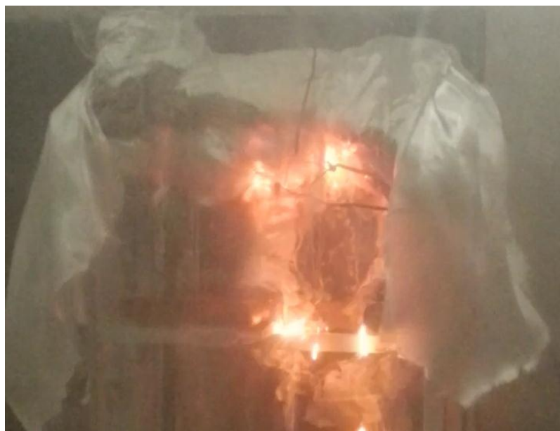
Рисунок 5.8 – Состояние модели через 13 мин с момента подачи натрия
