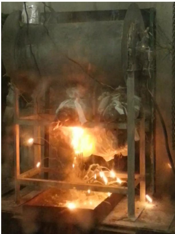
Рисунок 5.15 – Состояние модели через 2 мин с момента подачи натрия
