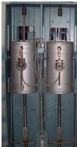
Рисунок 4.4 – Фото установки АИМА для проведения испытаний на длительную прочность и ползучесть
