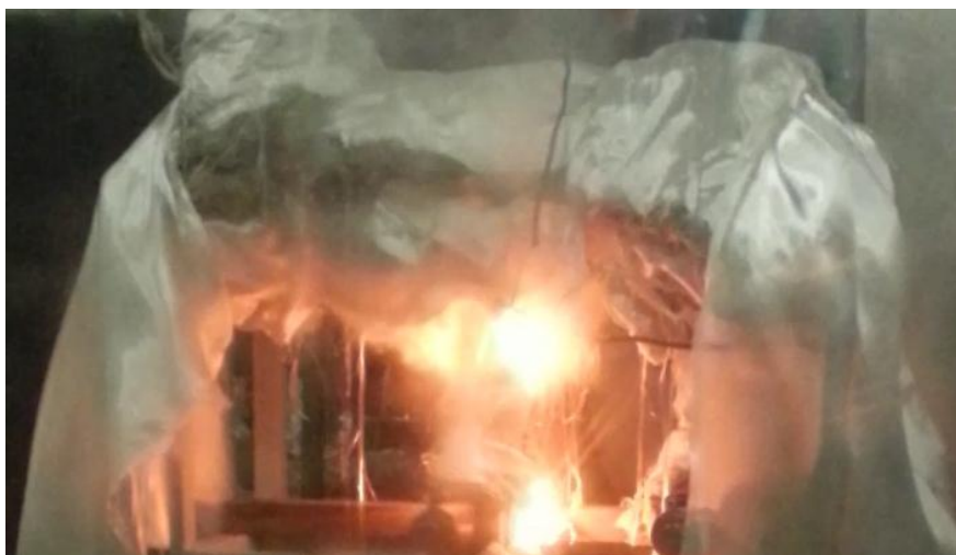
Рисунок 5.5 – Состояние модели через 20 с с момента подачи натрия в контур с надрезом
