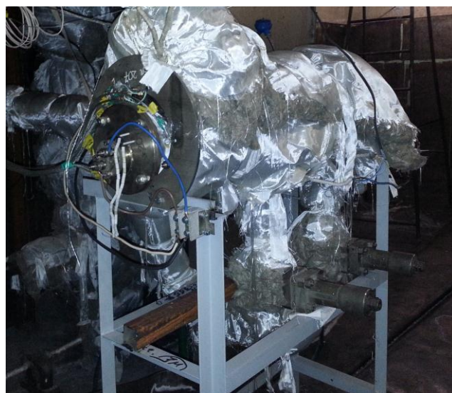
б) модель на раме, подключенная к стендовому оборудованию и покрытая теплоизоляцией
