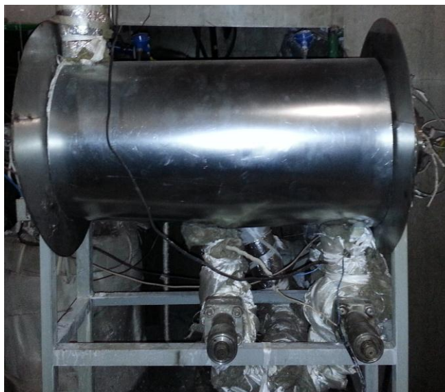
Рисунок 5.4 – Фото подготовленной к экспериментам № 2 и №3 модели с нанесенной теплоизоляцией и кожухом
