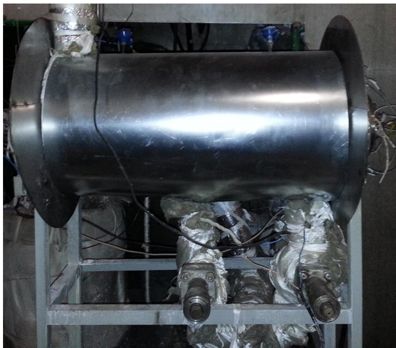
Рисунок 5.14 – Фото подготовленной к экспериментам №№ 2, 3 модели с нанесенной теплоизоляцией и кожухом
