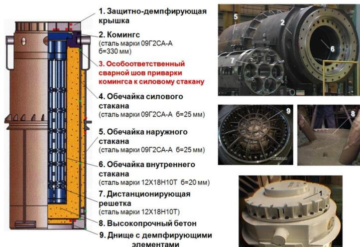
Рисунок 1.1 - Принципиальная схема и конструктивные элементы металлобетонного контейнера [1]
